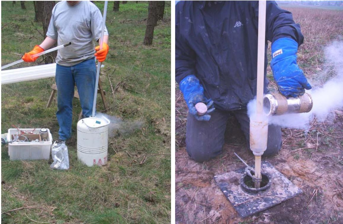
**Abb. A2.5: Verlängern (links) und Demontage (rechts) der Saugsonden mittels Schrumpftechnik**
