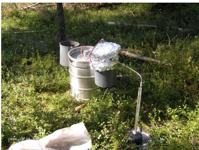
Abbildung 12.17: Probenahme für organische Spurenstoffe im Gelände
