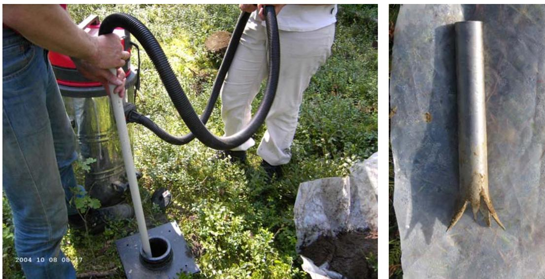
Abbildung 12.15: Saugbohrverfahren mit Stahlkronen
