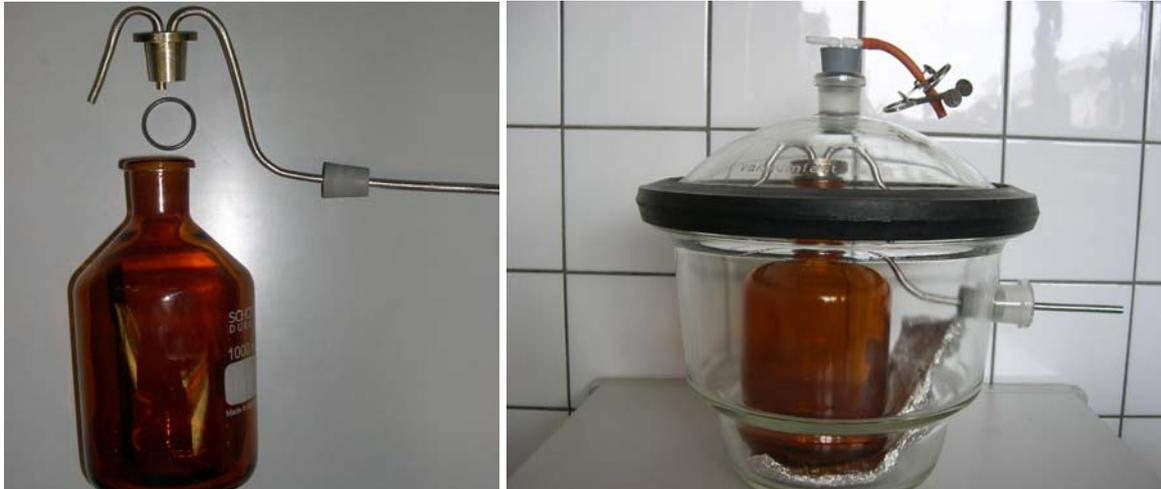
Abbildung 12.16: Explosionsdarstellung Exsikkator-Innenbauteile
