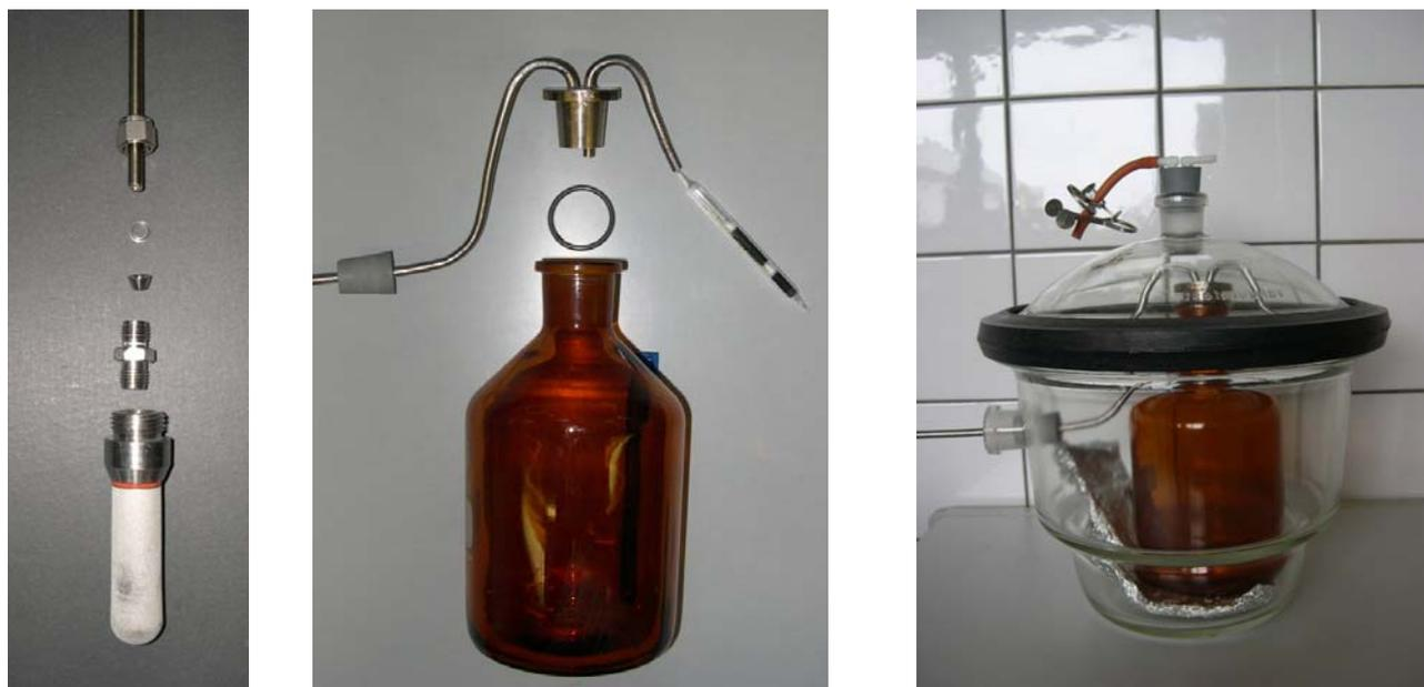
Abbildung 12.2: Photographische Dokumentation der Bauteile für die Saugsondenapparatur zur Gewinnung von Wasserproben für die organische Spurenanalytik
