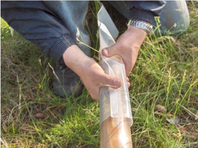
**Abb. A2.8: Überführen von Sedimentproben aus dem Übergangsbereich gesättigt/ungesättigt**
