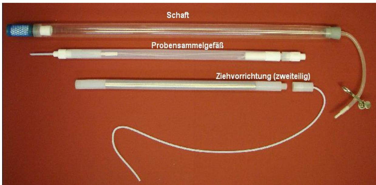
Abbildung 2.1 Hauptkomponenten der neuen Saugsonde. oben: Saugkerze mit Sondenschaft; mitte: Probensammelgefäß; unten: Ziehvorrichtung
